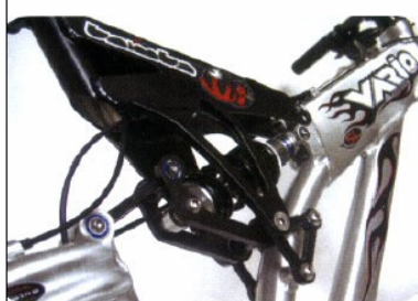
Vue de détail du mécanisme de suspension.
