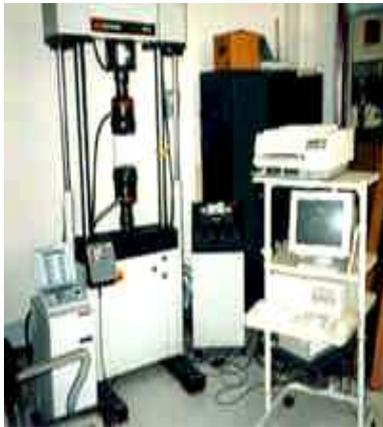
1 - Machine à essai de traction
