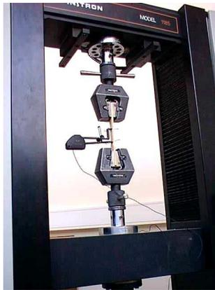
2 - Machine à essai de traction
