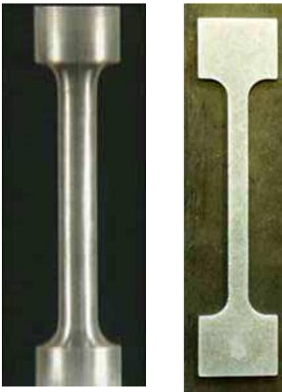
4 - Éprouvettes cylindrique et plane
