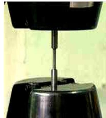
3 - Détail des mors et de l'éprouvette
