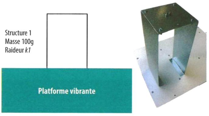
Afin d'obtenir sa raideur  $k$ , vous allez procéder à un essai statique : tirer avec un dynamomètre sur la structure jusqu'à ce qu'elle ait un déplacement de 10 cm.
