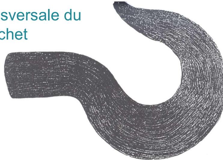
L'orientation de la structure ou fibrage est généralement déterminée en fonction des contraintes de service de la pièce.
